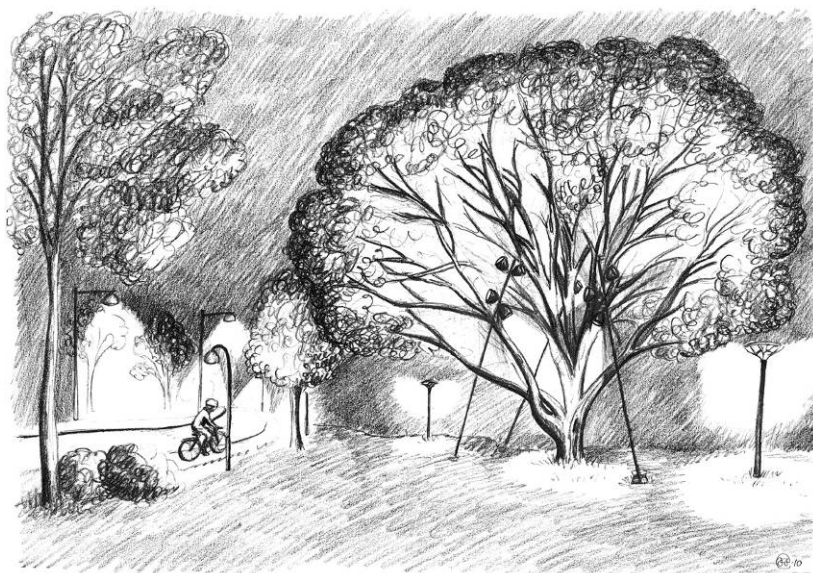
Förslag till gatu- och cykelbanebelysning samt belysning av de stora ekarnas kronor med små spotlights monterade på stag. Illustration Ljusgestaltning
