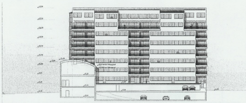
Fasad mot väster med sektion genom gymbyggnad och garagevåningar. Detaljplanen medger en ytterligare garagevåning.
